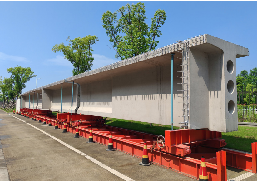
混凝土预制节段 T 梁
