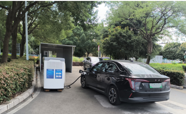
移动充电机器人在给新能源车充电。
