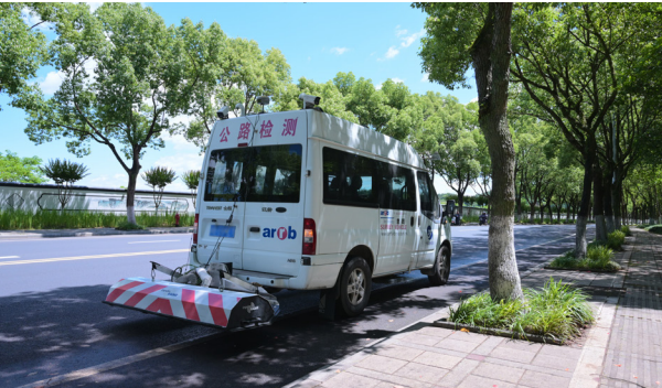
公路路况三维检测车巡检。
